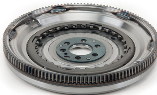
Fig. 1: Het aantal tanden op de starterkrans van het nieuwe onderdeel moet gelijk zijn aan dat van het oude onderdeel
